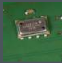
Компенсация давления воздуха Канальный датчик (Premium) с барометрической компенсацией давления воздуха при измерении CO2
